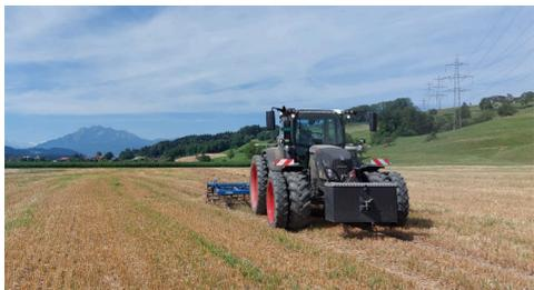
In einem ersten Durchgang werden die Stoppeln mit einem Leichtgrubber oder einer Scheibenegge bearbeitet und Ausfallgetreide zum Keimen gebracht.
