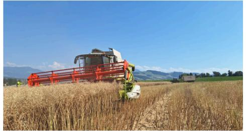
Dank Hangausgleich von bis zu 20% können auch steilere Parzellen verlustarm geerntet werden.
